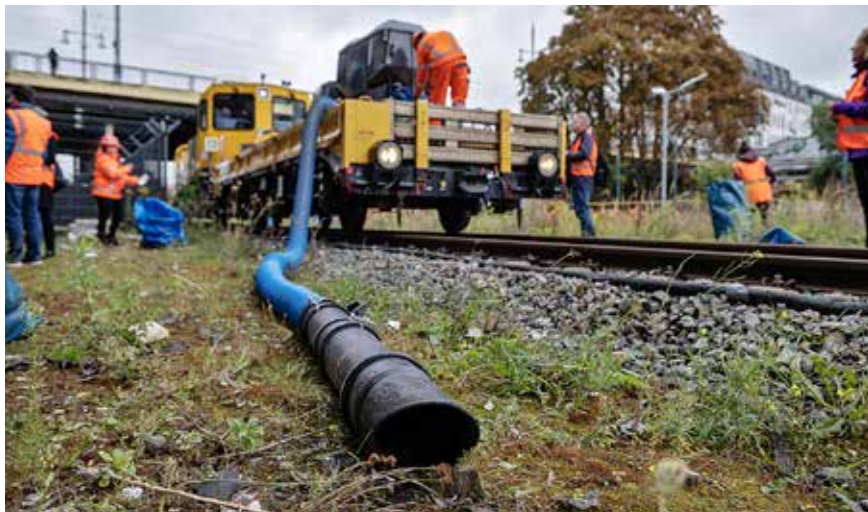
Das Vakmobile saugt kleinteiligen Müll von Gleisen und Schotter.
